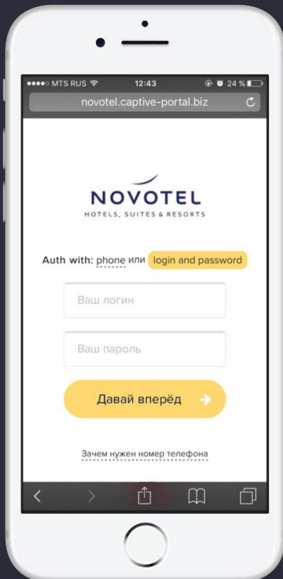
При подключении к Wi-Fi гость в качестве логина вводит номер своей комнаты, а в качестве пароля дату выдачи паспорта. Система авторизации проверяет данные о госте в системе управления отелем и при совпадении дает доступ в интернет. В данном случае требования законодательства полностью выполняются.
