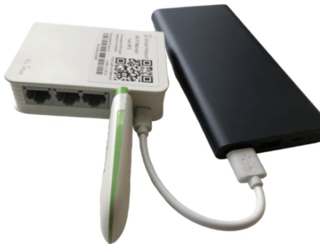
2. Если вы взяли Wi-Fi Магнит в аренду, то в нем уже установлены 3G модем с SIM-картой и SD-карта в разьеме, как показано на схеме. **Ни при каких обстоятельствах не вынимайте их из роутера! Часто на выставках мобильная связь работает не стабильно. Если магнит потеряет связь, то он будет в состоянии «Отключен» в личном кабинете. Чтобы ни один собранный MAC-адрес не потерялся, в аренду мы даем специальный роутер с офлайн сбором данных. Все собранные данные сохраняются на SD-карте в роутере.**
