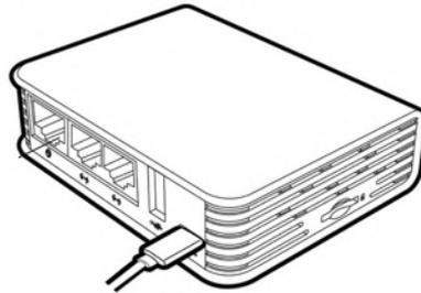
4. Дождитесь пока индикаторы 2G (сбор MAC-адресов) и 5G (передача данных в личный кабинет) на боковой панели роутера засветятся и начнут моргать. Это может произойти в течение 3 минут после включения роутера. Индикатор 2G моргает во время сбора MAC-адресов. Индикатор 5G моргает во время передачи собранных данных через Интернет на сервер Global Hotspot.
